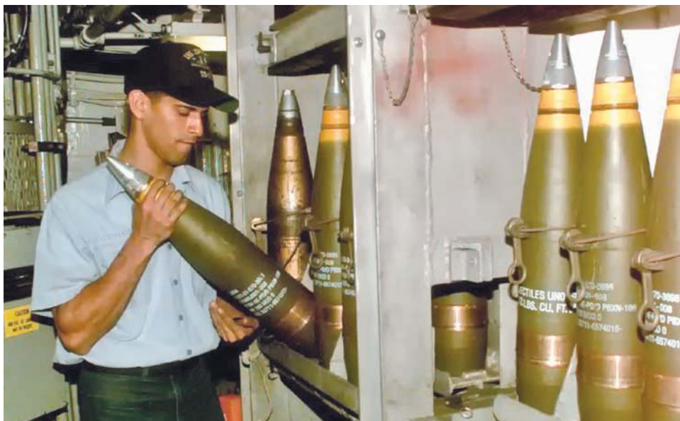
Класична муниција 127 mm за шoй Mk45 носи око 3,5 kg експлозива
