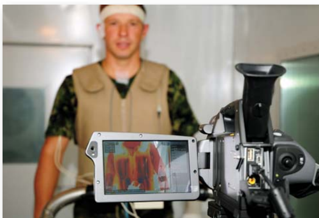
Термовизијски снимак љела: џамне површине указују на хладне зоне
