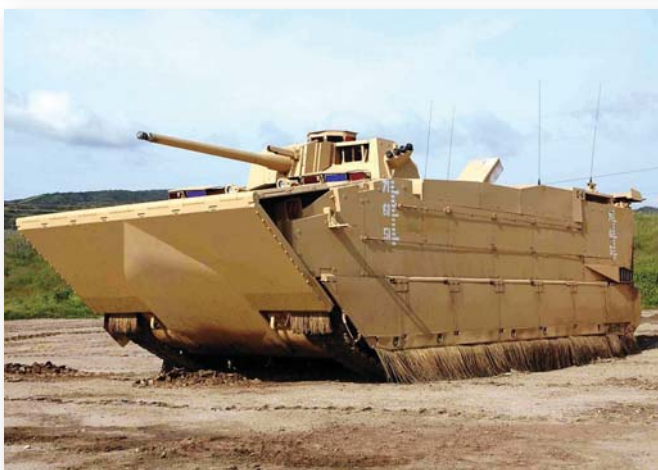
Употреба челика високе тврдоће 500 НВ омогућила је малу масу возила VBL
