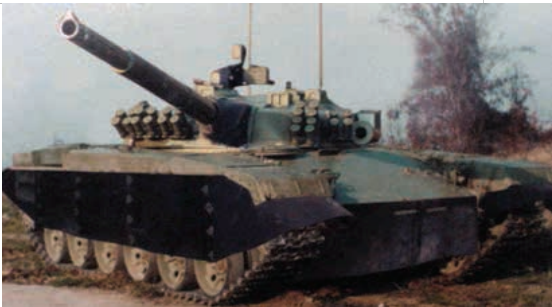
Функционални модел „вихора“ на шесту у вожњи (кућола је са макеће шенка)
