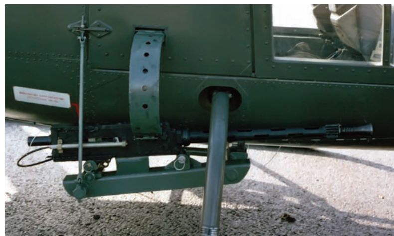
Друго решење уградње митраљеза МК II била је уградња на барку „газела” број 12870 на постољу са авиона „крагуј” (ВОЦ)
