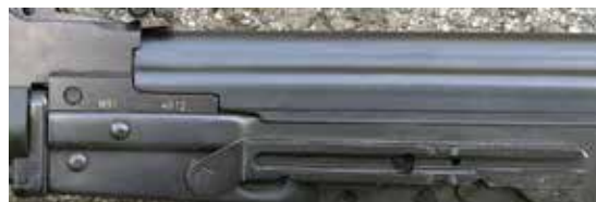
Снајперска пушка 7,62×54 mm М91, фабричка ознака на сандуку и детаљ носач оптичког нишана профила „ластин реп“ на сандуку пушке
