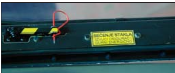
Инструментална табла предње кабине (горе) и детонационо сечиво система за катапултирање (доле)
