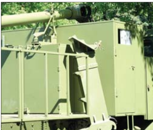
Иза кабине возача уграђени су кабина за послугу и магацин за муницију
