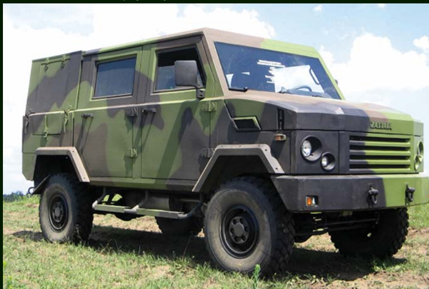
Аутомобил Шеренски 3к 1, 4 т, 4х4 т, 5+1 за превоз лица, функционални модел
