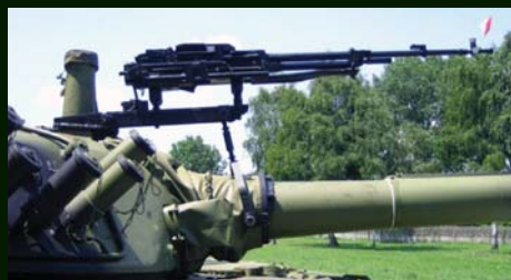
Миџраљез 12,7 мм сјрегнућ са шойом на шенку М-84 (М84-А)
