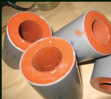
Инхибирани комади композитног ракетног горива
